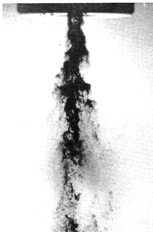
図 9.2 フラッシュ型噴口 case I \left( \begin{array}{ll} u_{g0} = 203.5 \text{ m/s} & w_{g0} = 4.71 \text{ g/s} \\ u_{l0} = 4.48 \text{ m/s} & w_{l0} = 13.27 \text{ g/s} \end{array} \right)
