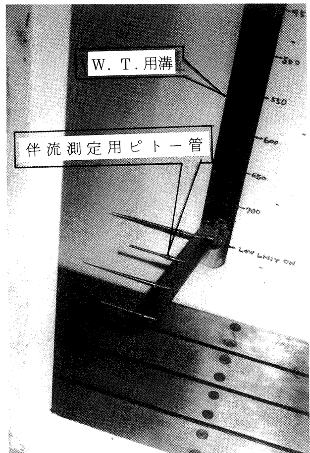
図 3.1(d) ウェークトラバース装置用溝と伴流測定用ピトー管（W.T. 付の状態）
