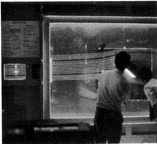
(c) Fume test in Fuji Heavy Industries Wind Tunnel (side view) 富士重の煙風洞における気流試験(側方)
