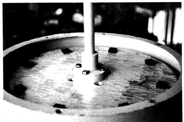
図 13 内側と外側ケースの間に入れたゴム
