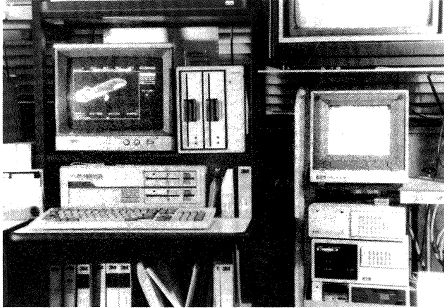
図3-2-2 赤外線温度計測システム(左側は熱画像データ処理装置, 右側は熱画像データ取得装置)
