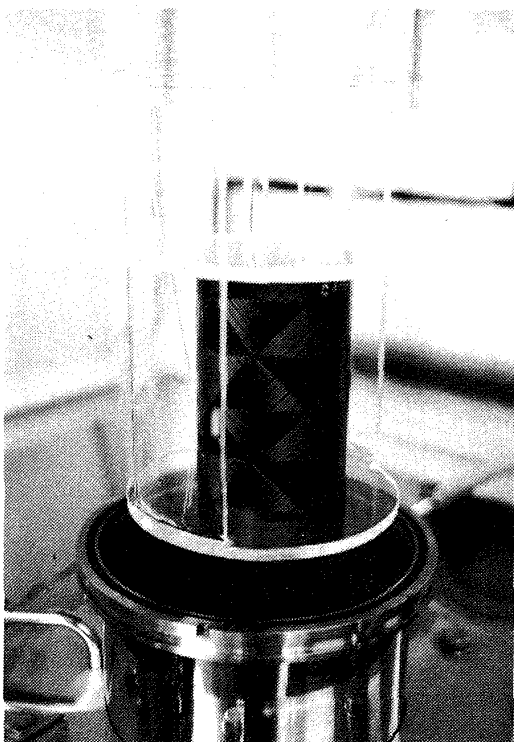
図18 TM-7000Sへ試験片をセットした状況
