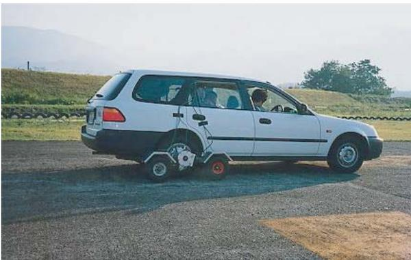
図 11. 乾燥路面上の摩擦係数測定装置
