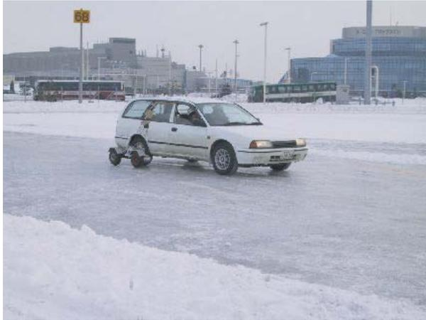
図13. アイスバーン路面測定の様子
