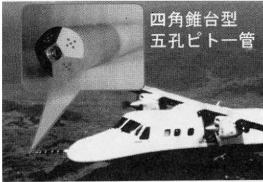
図4 4角錐台型5孔ピトー管
