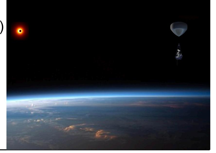
要旨 気球VLBI実験とは、成層圏に気球搭載型電波望遠鏡を滞在させ電波干渉計を形成できるかを検証する技術フィージビリティ・スタディである。将来のブラックホール直接撮像などの天文観測に向けた技術実証試験をおこなう。成層圏は、高周波電波帯(サブミリ波帯)の天文観測にとって、大気の影響をほぼ完全に避けることのできるサイトであり、地上の電波干渉計・スペースの人工衛星に次ぐ第三の観測プラットフォームとなりうる。最初のステップとして、受信周波数20GHz帯の口径1.5m電波望遠鏡を搭載したVLBIゴンドラ局と地上電波望遠鏡との間で Very-Long-Baseline Interferometry の干渉縞の検出を目指し、その性能評価をおこなう。前年度2017年、気象条件により放球が延期となっていた。2018年夏、この実験機を北海道広尾郡大樹町の JAXA 大樹航空宇宙実験場に輸送し、再び放球準備をおこなった。準備は順
