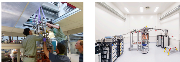
Fig 3. 左: Hybrid Cooler組み込み時の日仏共同作業。右: 完成後、Cryostat #3(X-IFU DM)試験用に作られた新しいクリーンルームに移設したCryostat#1。一番左にある黒いラック2台が日本から輸送したGSE。
