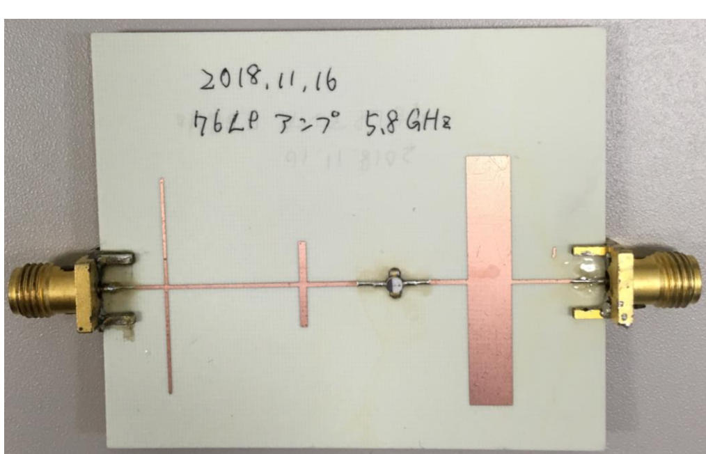
76LPを用いたパワーアンプの試作と実測値
