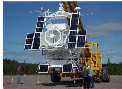
図 1: SUNRISE ゴンドラと口径 1m 望遠鏡
