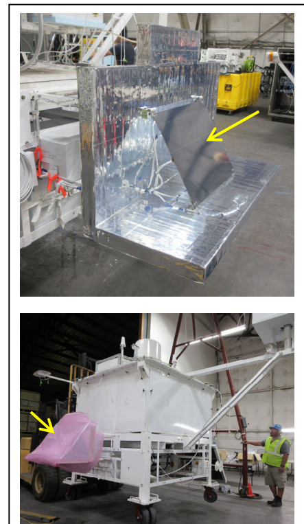
図 4. NASA#700NT に搭載されたラジエータスケールモデルの写真。(上)ラジエータおよび周辺の断熱壁の拡大写真。(下) ペイロード全体写真(ラジエータには地上待機時用の桃色の保護カバーが掛かっている)。
