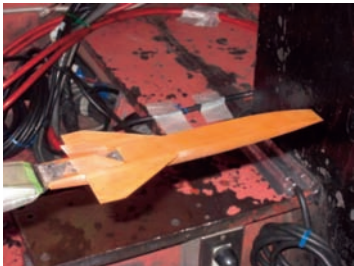
温度分布計測用ベスペル模型
