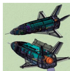
実験機 全長1.5m、重量50kg
