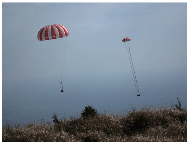
ヘリコプターからの投下による メインパラシュート展開試験の様子
