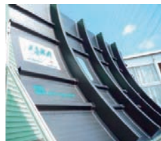
複合材による軽量化 VaRTM(真空樹脂含浸工法)とブリプレグを組み合わせた、低コストで丈夫な複合材構造技術の研究。構造軽量化による燃料消費量低減が狙い。
