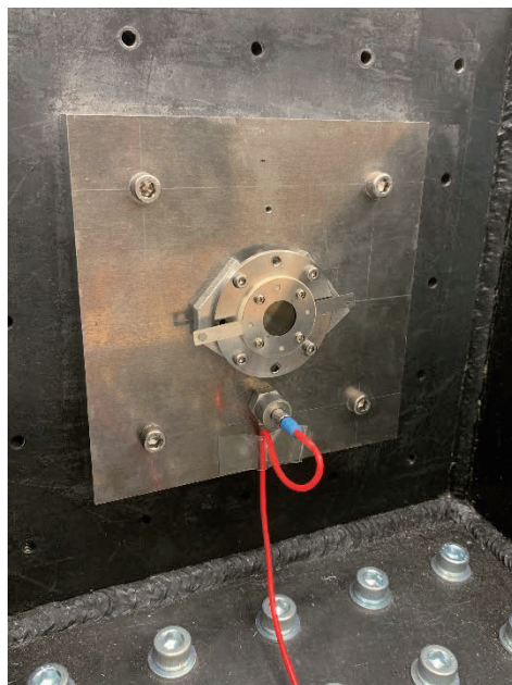
図 27. MCP の衝撃試験時における加速度センサの取り付け位置 供試体固定治具の中央に MCP アッセンブリを設置し、中央から約 40mm 下の位置に ネジ止めで加速度センサ 2 を取り付けている。
