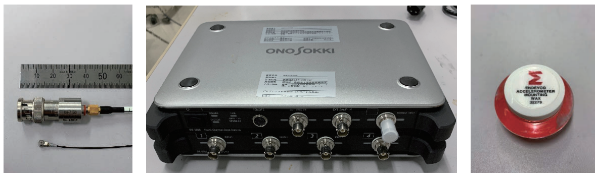
図3. 加速度センサおよびチャージコンバータ（左）データロガー（中央）接着剤（右）
