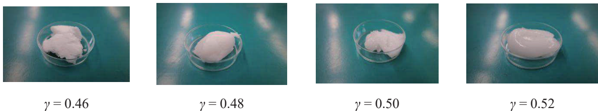
図 3. 100\ \mu\text{m} の KCl を用いた模擬推進薬の形状保持性
