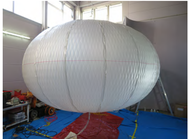
図 10: 2,000 Pa に加圧したゴム気球入り気球。
