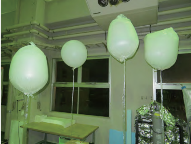
図 2: ゴム気球とゴム気球にポリエチレン袋をかぶせた気球の試験の様子。
