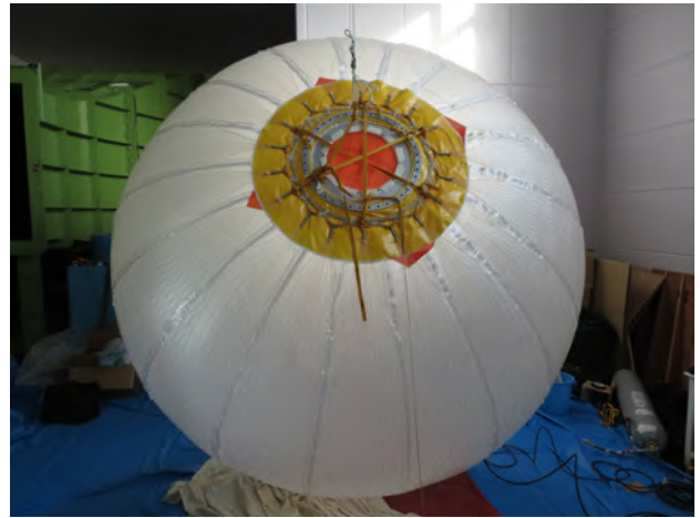
図 8: ウレタン布による気球頭部の保護。
