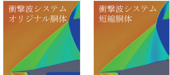
図11. ランプ衝撃波パターンの比較 7)
