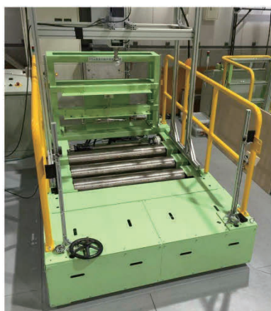
ドラム式耐久性試験機 (6輪タイプのロボットにも対応) 最高速度15km/h, 耐荷重250kg
