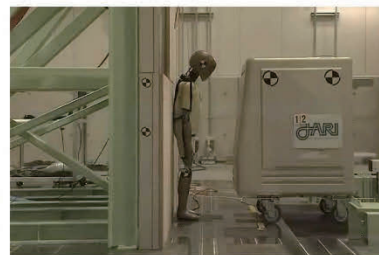
低速用衝突試験装置 牽引速度 1 ～ 20 km/h
