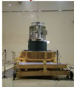
ESMS音響試験 (ダミー衛星搭載)
