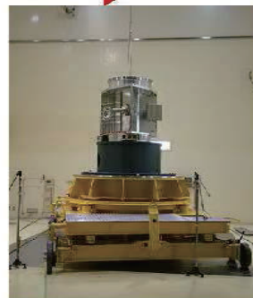
ESMS音響試験 (ダミー衛星搭載)
