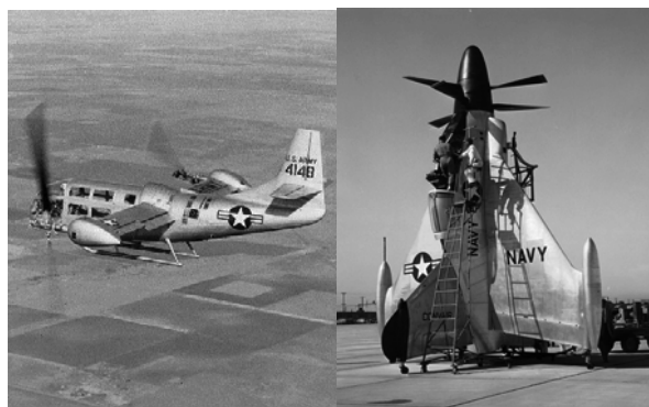
図3 ベルXV-3(チルトロータ, 1955年, 左) [3] , コンベアXFV-1(テイルシッター, 1954年, 右) [4]
