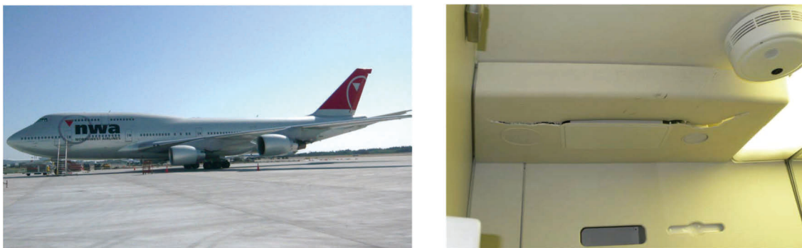
Fig. 4.6-1 事故機（左図）と化粧室天井部の亀裂破損状況（右図）。出典：運輸安全委員会事故調査報告書 4.8.2)
