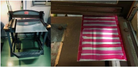
図4 薄板切断機（左）と切断する時の様子（右）
