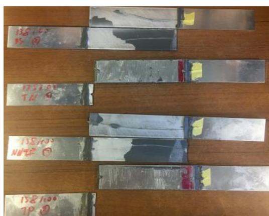
図 12 AV138, 100mm の破断試験片
