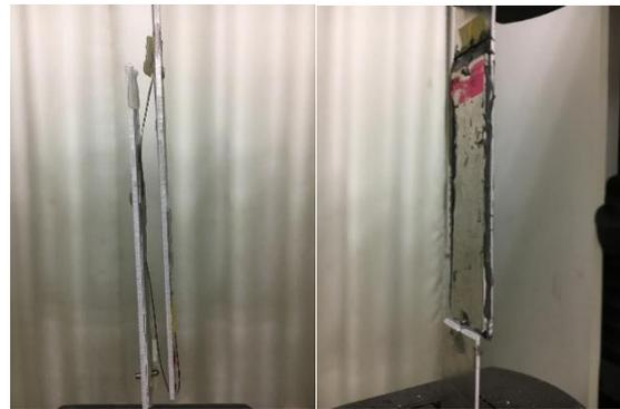
図8 接着層からの破断（左）、板のネジ穴部の破断（右）
