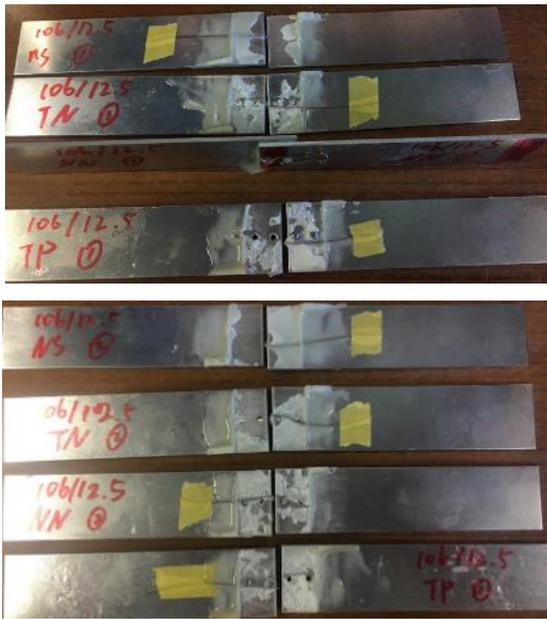
図 14 AW106, 12.5mm の破断試験片
