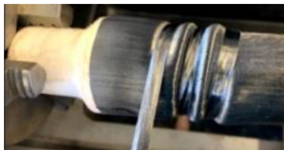
図 2 帯状のプリプレグ ( h ) の巻き付け
