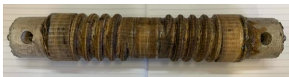
図 3 3D プリンタで成形した型
