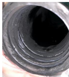
図 19 燃焼後 CFRP 製モーターケースねじ
