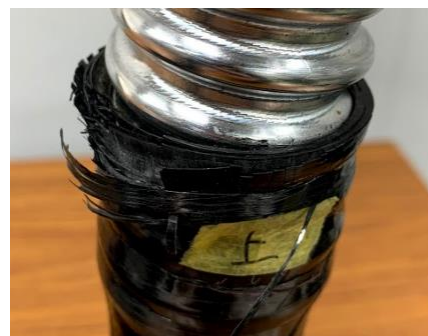
図8 フープ方向に破断した試験片
