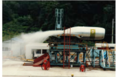
水噴射による排気流れの見視化 (STOL機/高馬力搭載用FJRエンジン試験 (航空宇宙技術研究所自田支所))
