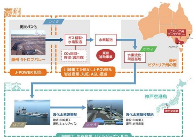
図3. 実証計画中の液化水素サプライチェーン<sup>2)</sup>
