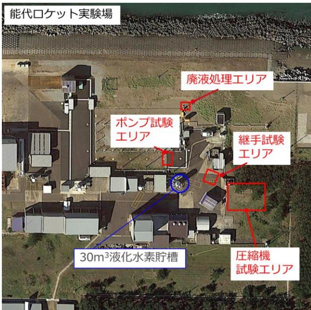
図7. 試験エリア配置計画
