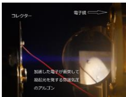
図2 電子銃から電子ビームを照射している様子、右にある電子銃から右のコレクタに向かって電子が加速されている
