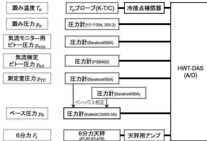
図 2: JAXA 極超音速風洞 6 分力計測に関わる計測系概要
