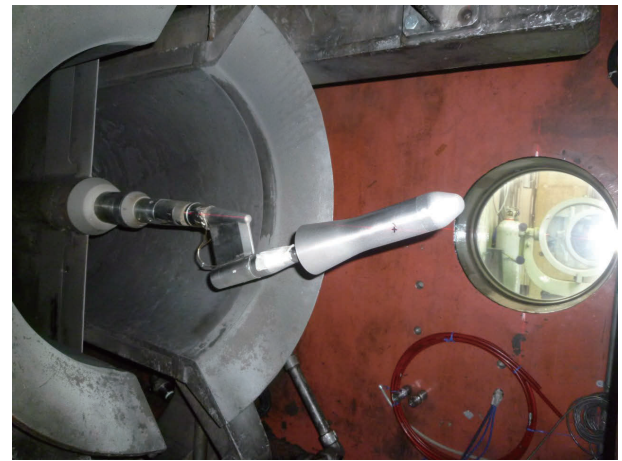
(b) HB2 模型 20deg 曲りスティング支持
