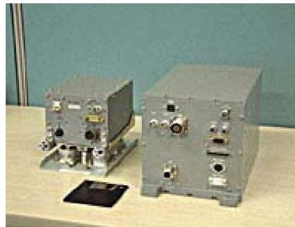
GPS補強型慣性航法装置GAIA
