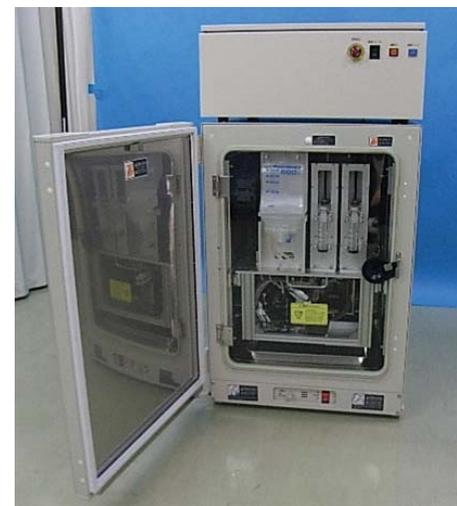
試作自動継代培養装置
