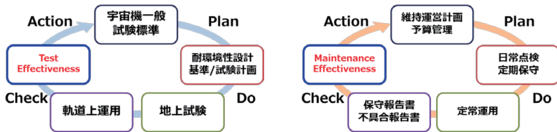
図 8 試験有効性検討（左）と保全有効性検討（右）の位置付け
