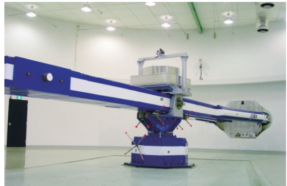
(f) 旋回腕型加速度試験設備
