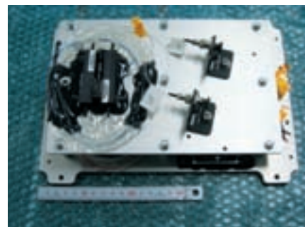
H21年度製作中の搭載型FBGによるAE計測システム
