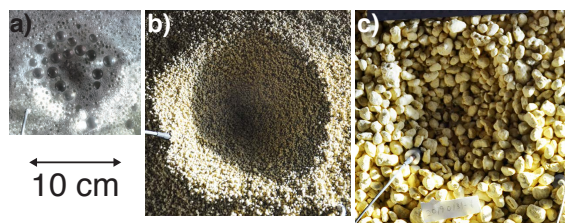
図1 クレーターの写真. a) 混合ビーズ, b) 細粒風化凝灰岩, c) 大玉風化凝灰岩. スケールは全て同じである。a)は弾丸半径が1 mm, b)とc)は2 mmのアルミ球を使用した。
