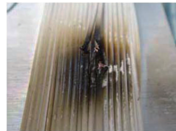
直径0.3mmステンレス、 衝突速度4.01km/s
