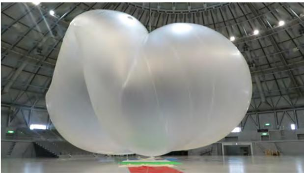
図 3: 変形しながら破壊する NPB7-1 気球。
