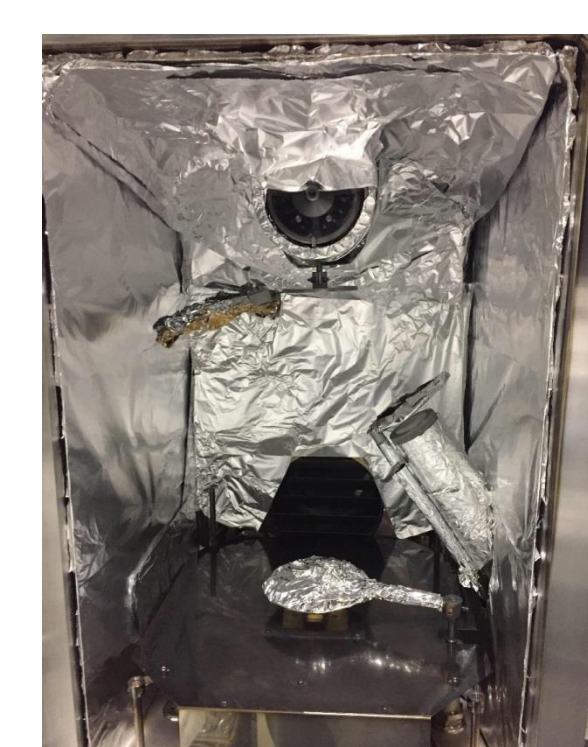
EB蒸着&スパッタ装置
