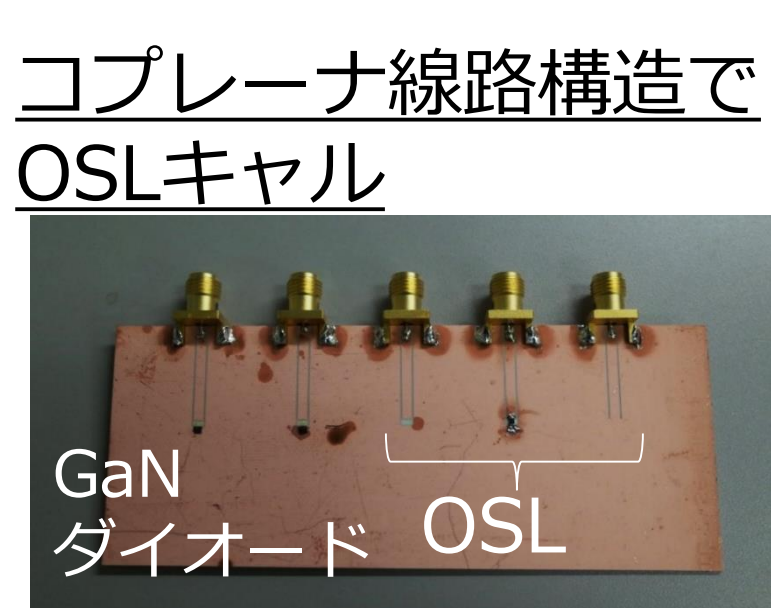
5.8 GHzのGaNダイオード計測
