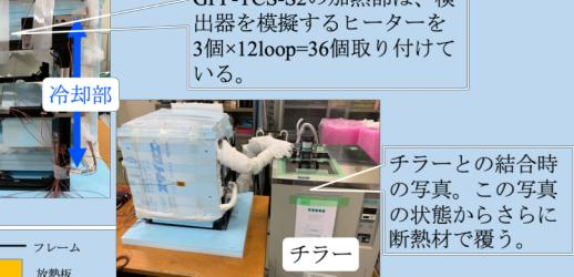
チラーとの結合時の写真。この写真的状態からさらに断熱材で覆う。
