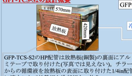
GFP-TCS-S2のHP配管は放熱板(銅製)の裏面にアルミテープで取り付けた(写真では見えない)。チラーからの循環液を放熱板の表面に取り付けた1/4in配管に流すことで放熱板と冷却板を一体化。
