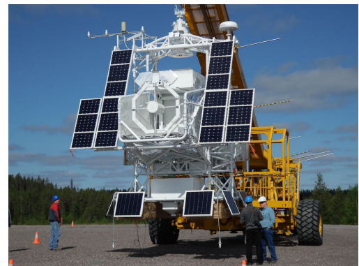
図1: SUNRISE ギンドラと口径1m望遠鏡 (2013年のSUNRISE-2フライトより)
