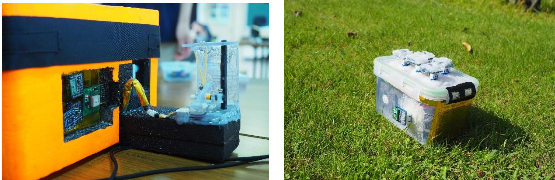
写真 1 : (左) 露出型天然ゴム張力測定器 (右) 完全防水ユニット
