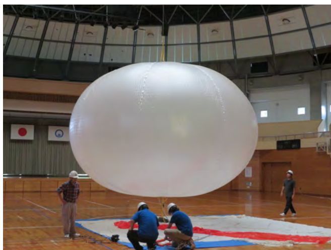
図 1: 耐圧試験時に満膨張となった気球。
