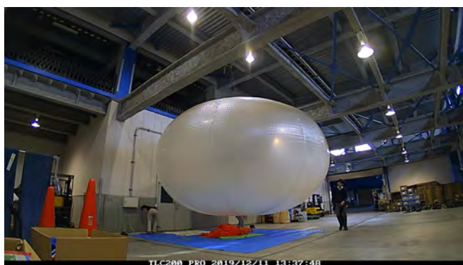
図 3: 気密試験時に満膨張になった気球
