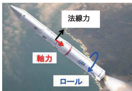
第 1 図 次期固体 (現 イプシロン) ロケットの CG イメージと主要な空力特性
