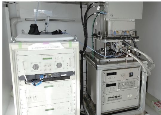
Ka 帯受信 RF インタフェース装置（左）と低雑音増幅装置（右）
