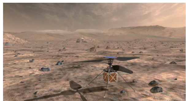
図4 NASA-MHで採用された2重反転ロータ型 7)
