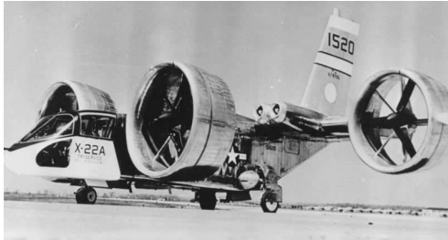
図2 ダクテッドファンを用いたVTOL機の例. Bell X-22(1966) 4)
