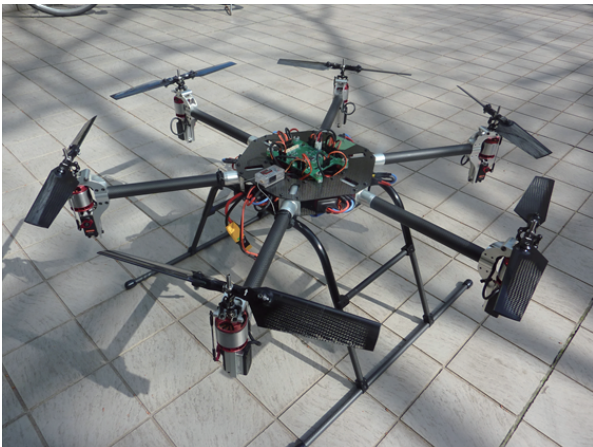
図6 可変ピッチ制御の6ロータ試作機 9)
