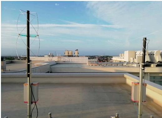
図5 簡易型受信機（左が 144 MHz 帯アンテナ，
