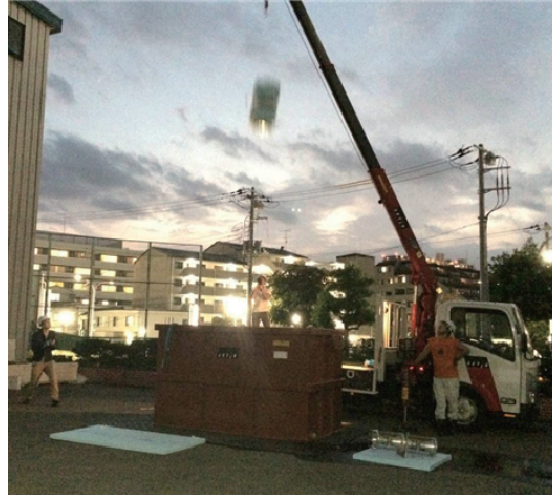
図6. 採取部の水中投下試験の様子。実際の気球実験で用いる保温材を取り付けた採取部をクレーンで吊り、フックを用いて水を貯めた水槽へ自由落下させ、着水衝撃を模擬する。着水速度が実際の気球実験と同じ7 m/sの場合（ラン1）では高度2.5 mから、着水速度が実際の気球実験より大きい9 m/sの場合（ラン2～10）では高度4 mから、それぞれ投下した。
