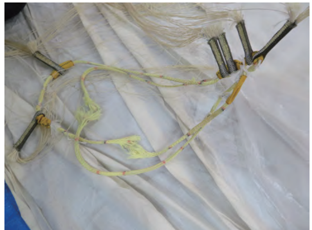
図 33: 破損した尾部側ロープリング。
