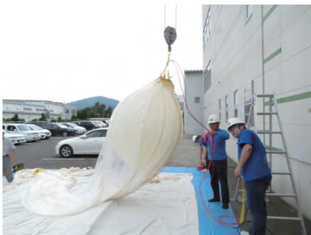
図 10: 気球頭部から空気を注入
