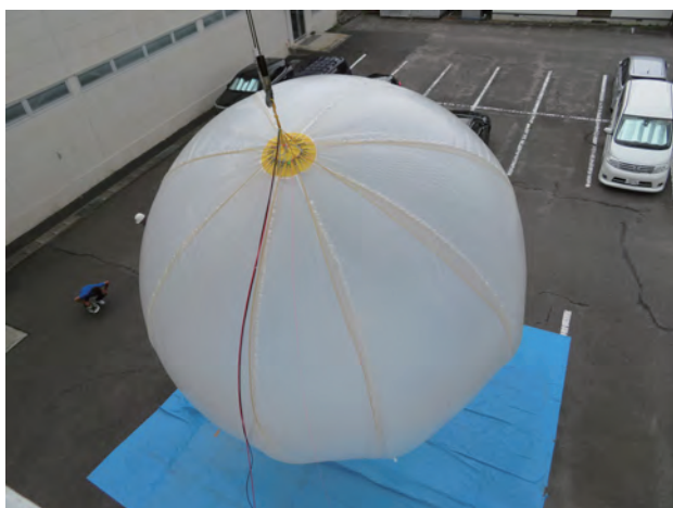
図 12: 70 Pa 印加時の気球の網の偏り (頭部)
