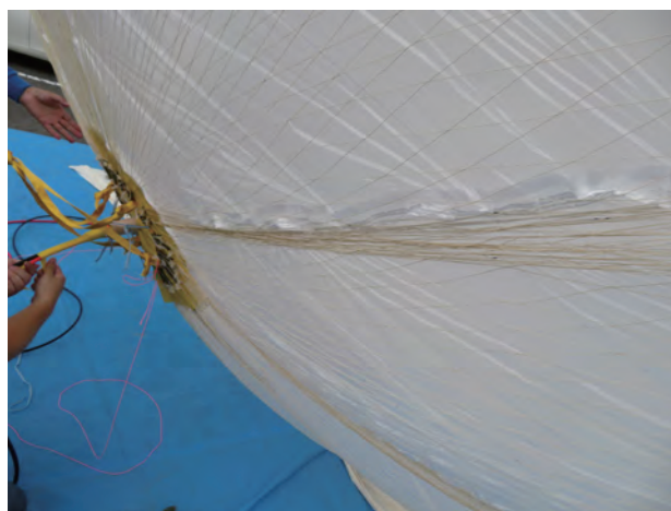
図 13: 70 Pa 印加時の気球の網の偏り (尾部)
