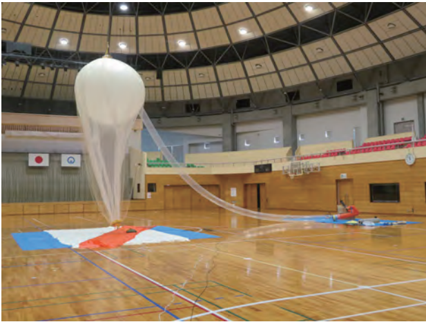
図 30: ブロウワによる空気注入。
