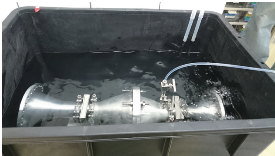
図8. 採取部水没試験の様子
