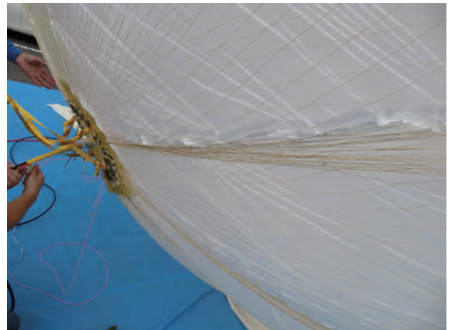
図 13: 70 Pa 印加時の気球の網の偏り (尾部)
