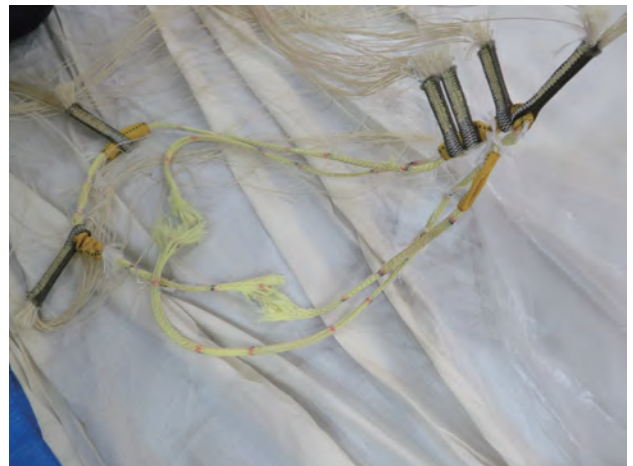
図 33: 破損した尾部側ロープリング。
