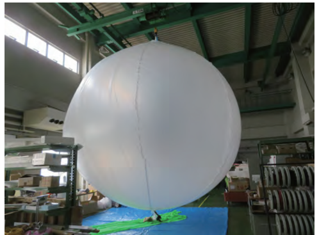
図 4: 最大膨張状態の気球 (間に空気あり)。
