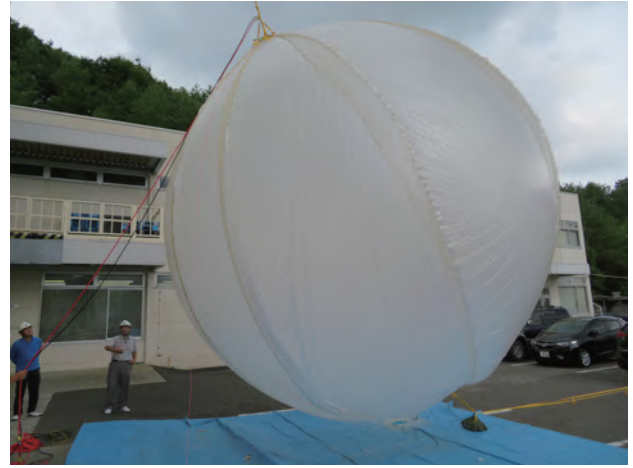
図 11: 70 Pa 印加時の気球の網の偏り (側面)
