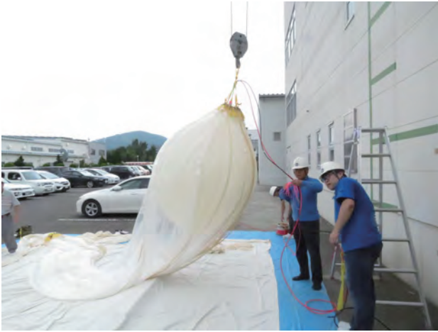
図 10: 気球頭部から空気を注入
