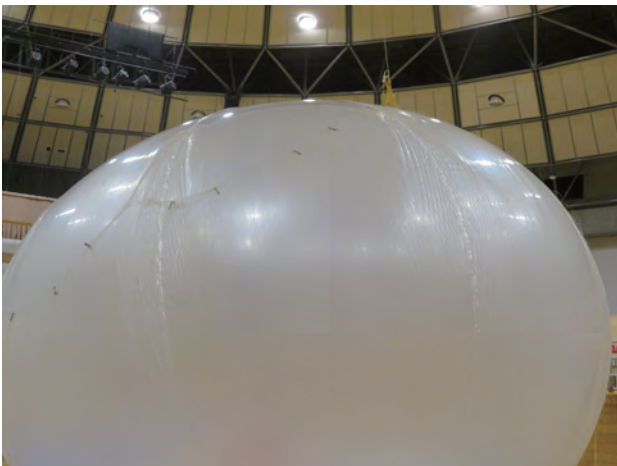
図 32: 破壊した気球の頭部。
