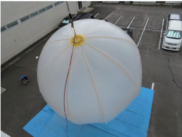
図 12: 70 Pa 印加時の気球の網の偏り (頭部)
