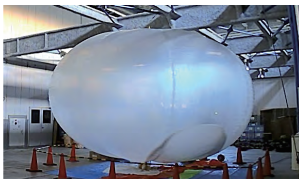
図 25: ゴム気球破裂後の気球。ゴム気球が下にある。
