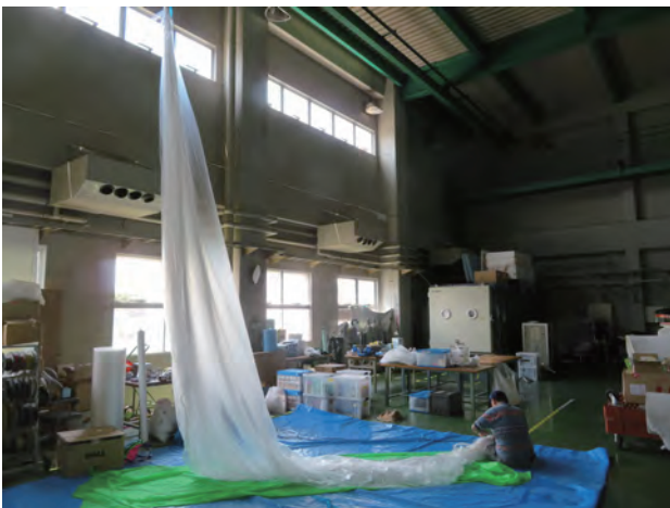
図 3: 間に空気を注入した NPB01-4 の皮膜。
