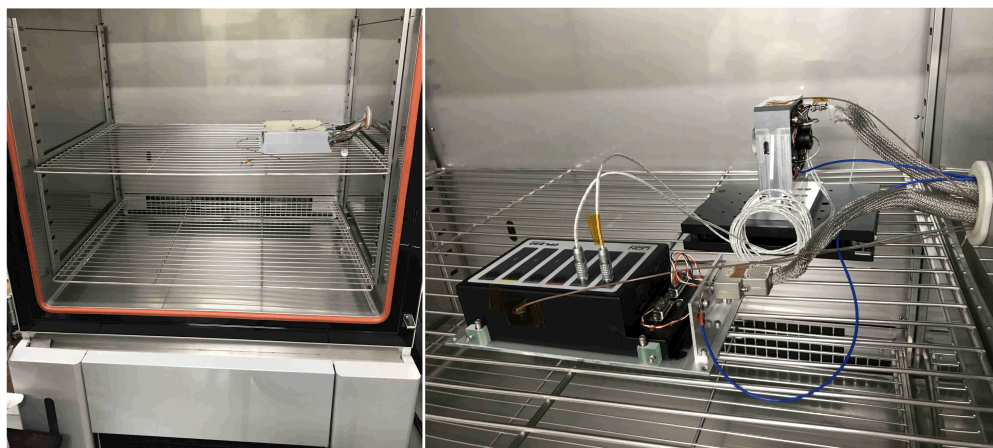
図 14. 左)恒温槽内に SMM-DRV を設置している様子. 右)恒温槽内に SMM-TM・SMM-IF を設置している様子.
