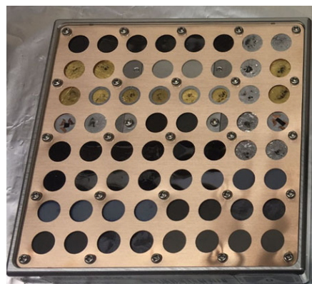
図4 QCC型曝露装置
